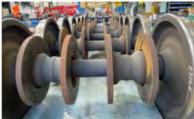
Essieux et plaquettes de freins extraits du bogie (sorte d'essieux d'une rame de train) en cours de remise en état
