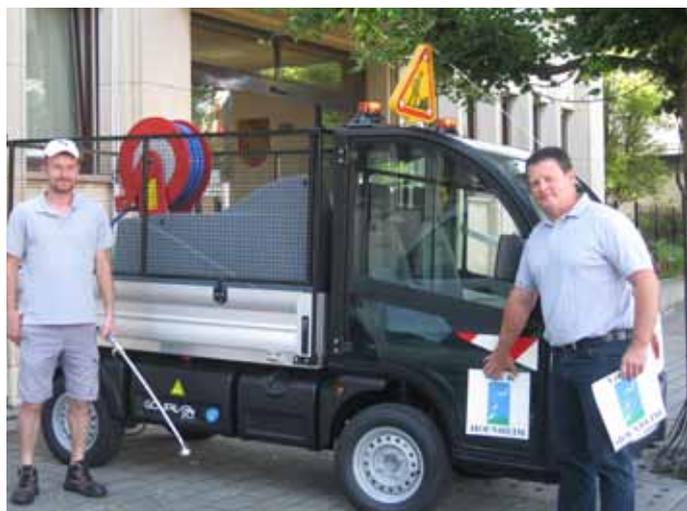
Le nouveau véhicule électrique, avec une cuve de 500 litres, permet aux services techniques d'arroser avec l'eau de pluie sans bruit et sans pollution (Photo DEWH)
