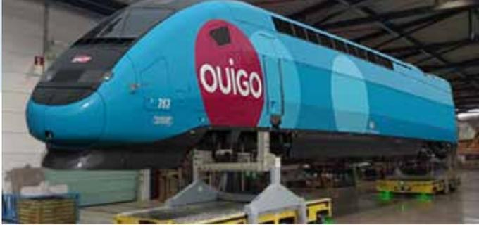
Le locotracteur permet de soulever les caisses et de s'affranchir des déplacements internes sur les rails. Un gain de temps et une réduction des bruits pour les riverains (Document remis)
