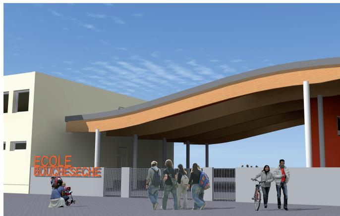
L'ouvrage comportera des poteaux en béton armé et une charpente en lamellé collé, à l'image de la structure de l'école maternelle voisine (Document cabinet Keller)
